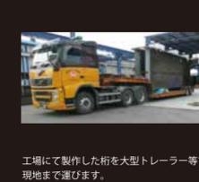
工場にて製作した桁を大型トレーラー等で現地まで運びます。
