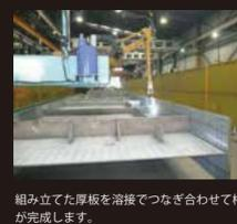
組み立てた厚板を溶接でつなぎ合わせて桁が完成します。
